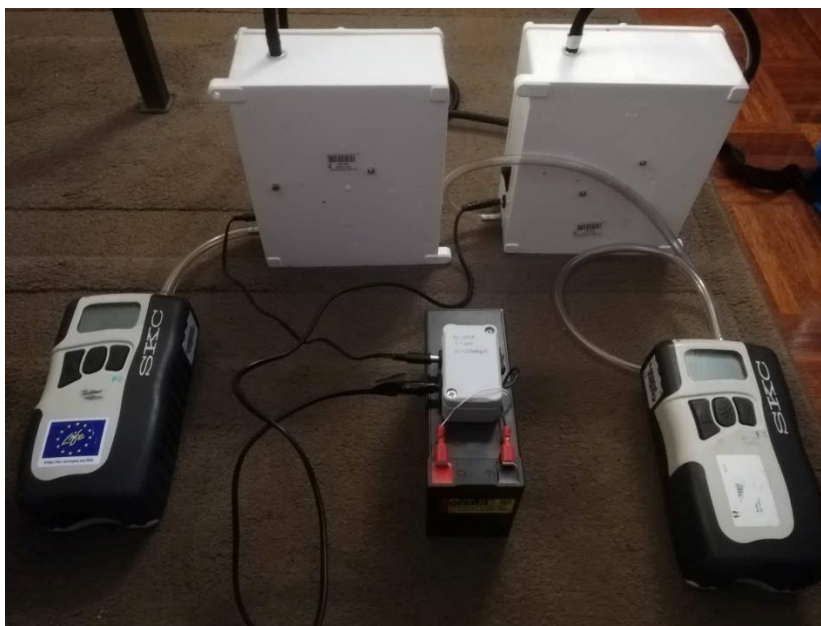
Figura 4 - Sistema ExpoLIS com duas bombas SKC Leland Legacy. A bateria de chumbo (no meio) fornece energia às duas caixas.
