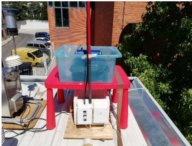
Figura 16 - Teste com o protótipo do sistema ExpoLIS, na estação de monitorização da qualidade do ar dos Olivais (25 maio–8 junho).
